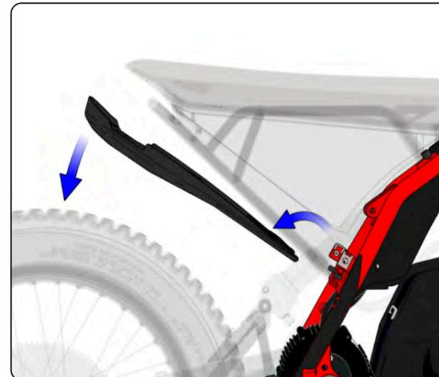
Der Spritzschutz kann jetzt entfernt werden und legt die Bodenschrauben der gepolsterten Sitzbank frei.
