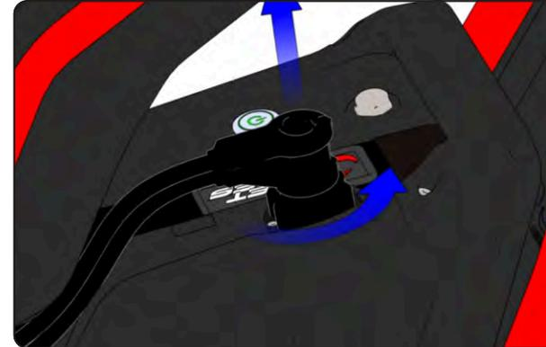
Batterie ausbauen: Batterie-Hauptstecker entfernen, indem Sie die Manschette des Anschlusses gegen den Uhrzeigersinn drehen.
