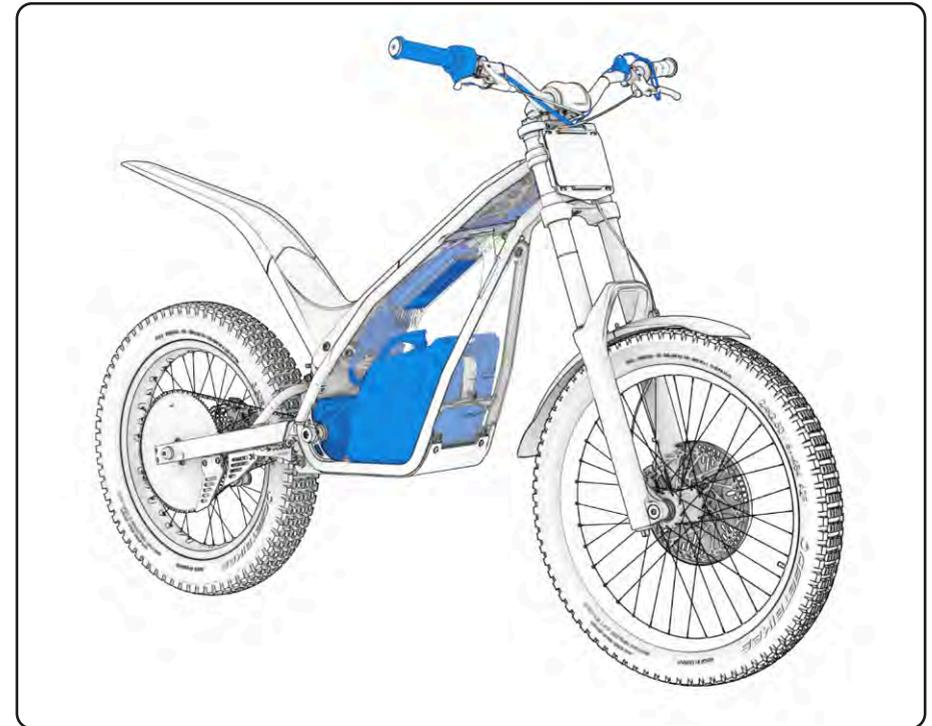
Der Controller ist bewusst versiegelt. Jeder Versuch, ihn zu öffnen, zerstört ihn. **Der Controller ist kein zu wartendes Bauteil.**
