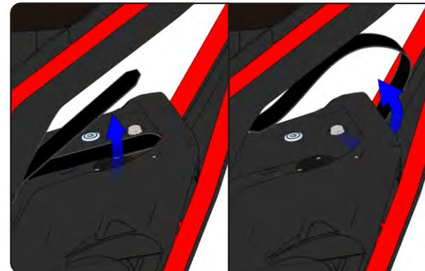
Lösen Sie den Batteriegurt vom Batteriegriff.
