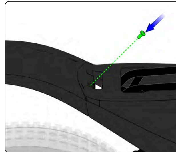
Das Kunststoffteil mit den übrigen, zuvor entfernten M6x16 mm Flanschschrauben befestigen.
