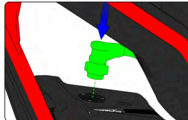
Das Stromkabel für die Batterie anschließen. Richten Sie den Stecker anhand der Markierungen aus. Drücken Sie den Stecker herunter, bis Sie ein Klickgeräusch hören.
