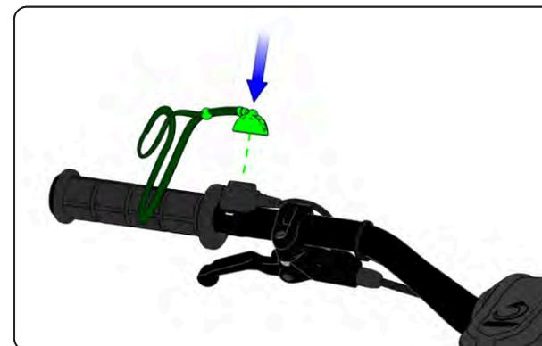
**Bike starten:** Die Batterie muss eingeschaltet sein. Das Gurtband wird am Handgelenk des Fahrers befestigt und mit der Magnetkappe verbunden.
