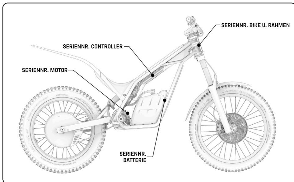
Die Seriennummern von Bike, Motor, Batterie und Controller befinden sich an den Stellen laut obigem Diagramm.
