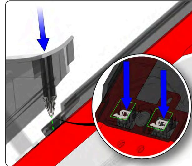
Das Vorderteil herunterdrücken, bis sich die Clips im Rahmen befinden.
