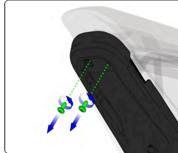
**Befestigung des hinteren Kotflügels:** Zuerst die x2 M6x16 mm oberen hinteren Spritzschutz-Flanschschrauben entfernen.
